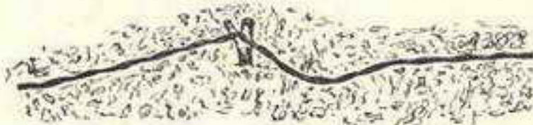
Sl. 26 — Izdignut nastavak (ili deo kabla sa slabom izolacijom)
